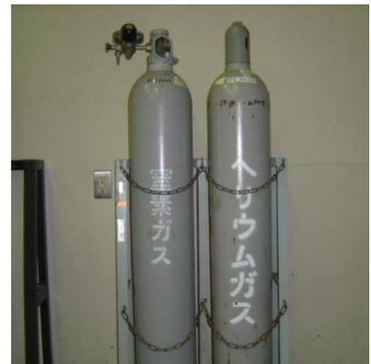
Fig. 13. 高圧ガスの固定方法
