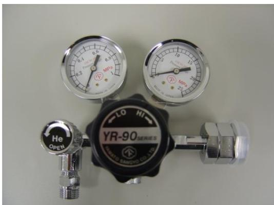
Fig. 14. ヘリウムガス（及び可燃性ガス）用：
