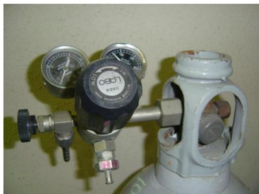
Fig. 15. 窒素ガス（等の一般ガス）用：右ネジ
