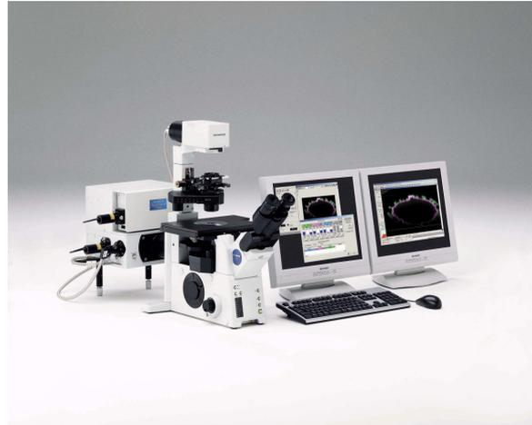
FLUOVIEW FV1000-D は、固定標本や生細胞標本の多重蛍光染色標本を簡単かつ明るく撮像することが出来る、レーザ走査型顕微鏡です。ソフト上から操作が出来る電動ステージや、焦点を保持するための ZDC(Zドリフト補正機構)を組み合わせることで、長時間に渡る生細胞の共焦点観察も可能です。また広範囲に渡る詳細画像観察や貼り合せ画像の構築も出来ます。また、光刺激専用のスキャナを有しており、生細胞の挙動観察を行いながら mSec オーダーでの時間制御で刺激光を照射することも出来ます。
